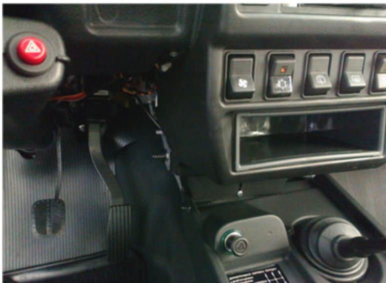
Кондиционер интегрирован в существующую систему вентиляции и отопления. Осевой вентилятор отопителя заменён на радиальный, с увеличенной производительностью (до 310 куб. м воздуха в час). Система оборудована регулятором температуры охлаждённого воздуха и может работать в режиме рециркуляции.
